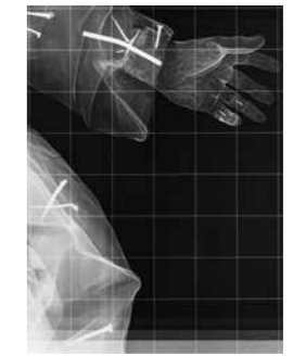
FIG. 9.- Radiografía de la mano izquierda de la imagen de Judas Iscariote del Paso de La Cena, donde se puede apreciar el hierro cilíndrico insertado para fijar la mano al resto de la imagen, aplicado en una restauración de la escultura. Fuente: Centro de Restauración de la Región de Murcia.
