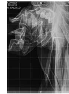
FIG. 8.- Radiografía de la mano derecha de la Virgen de los Dolores de la iglesia de Santa Catalina, donde se puede apreciar el hierro cilíndrico insertado para fijar la mano al resto de la imagen, aplicado en una restauración de la escultura. Fuente: Centro de Restauración de la Región de Murcia.
